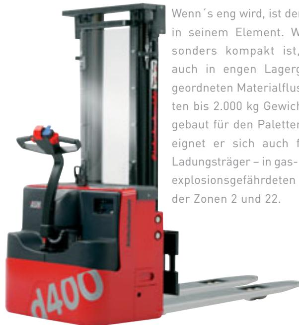
Wahlweise können d100/d400 Deichselfahrzeuge mit einer klappbaren oder feststehenden Plattform ausgestattet werden, die es ermöglicht, das Fahrzeug im Mitfahrbetrieb mit einer Fahrgeschwindigkeit bis zu 10 km/h, im Mitgängerbetrieb bis zu 6 km/h zu nutzen, sodass die Manövrierfähigkeit auch unter engen Platzverhältnissen gewährleistet ist.
